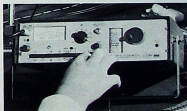
Bild 3. Frontansicht des Feldstärkemeßgerätes „HFV“
